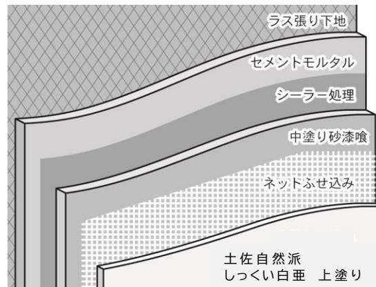
2. シーラー塗布後、乾き具合を見て、砂漆喰をモルタル面にすり込むように下塗り後、上付けし塗厚5mmに塗り付けてください。その後すぐに、クラック防止ネットを全面にコテで伏せ込み、その上からネットの目が隠れる程度に砂漆喰を塗り付け、木コテで平坦にならしてください。クラック防止ネットの継ぎ目は5cm以上重ね貼りし、幅が1mに満たない面はカットして調整してください。
